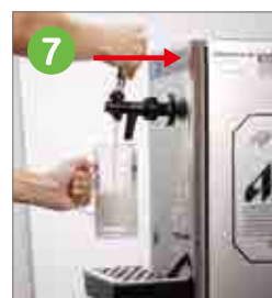
コックのレバーを押して、泡出しをします。
