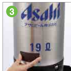
ガス圧チェックカードで樽の温度を測定します。
